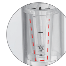
过滤器采用高性能垂直单面(0.5mL)/双面(5mL、15mL)聚醚砜(PES)膜结构设计,更大的有效过滤面积,液体流速更高
